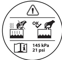
Надпись расположена на крышке расширительного бачка. Используется для напоминания о том, что не следует открывать крышку расширительного бачка при перегреве двигателя, чтобы избежать ожога.
