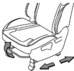
Возьмитесь за середину регулировочного рычага и потяните его вверх. Сдвиньте сиденье назад и вперед в требуемое положение, затем отпустите регулировочный рычаг.
