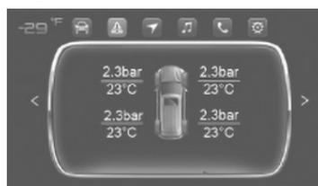
Отображение соответствующих значений давления и температуры в шинах.
