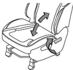
Обопритесь о спинку сиденья. Поднимите рычаг регулировки угла наклона спинки. Наклонитесь вперед или назад, чтобы отрегулировать спинку под нужным углом, а затем отпустите регулировочный рычаг.
