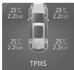
Отображение соответствующих значений давления и температуры в шине.
