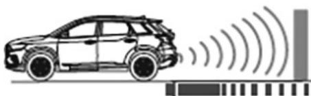
Радар заднего хода - это устройство радиолокационного обнаружения. Во время движения задним ходом датчик определяет наличие препятствия позади автомобиля и расстояние от препятствия до автомобиля и подает звуковой сигнал, чтобы обеспечить безопасную и легкую парковку и избежать столкновения.
