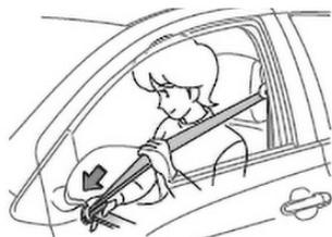
1. Возьмитесь за пряжку ремня и вытяните ремень безопасности из втягивающего устройства. Следите за тем, чтобы не перекручивать его.
