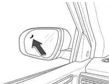
Когда другой автомобиль, движущийся в попутном направлении, входит в опасную зону, система предупреждает об этом водителя световым сигналом на наружном зеркале и звуковым сигналом в салоне. Предупреждающая лампа на зеркале имеет два режима яркости, - дневной и ночной.
