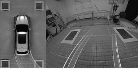
При повороте рулевого колеса траектории колес поворачиваются на такой же угол и показывают куда пойдет автомобиль.
