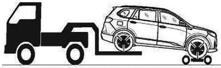
• Эвакуатор с подъемником (для задних колес)
