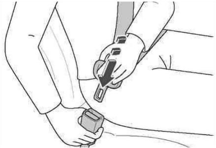
2. Плавно вытяните ремень из натяжителя. Разместите ремень вокруг груди и бедер. Вставьте язычок ремня в замок. При фиксации язычка в замке раздается щелчок, означающий что ремень застегнут.
