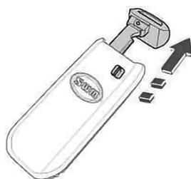
2. Для извлечения механического ключа, нажмите стопорную и вытяните ключ.
