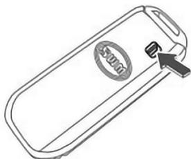
1. Нажмите стопорную кнопку механического ключа на корпусе электронного ключа.
