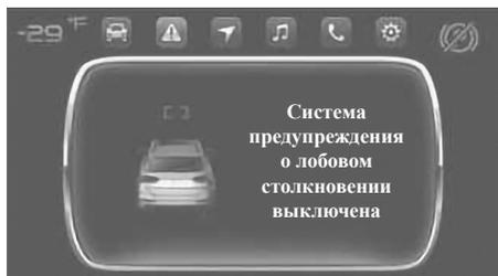
● При отключенной системе на приборной панели в виде соответствующей подсказки отображается предупреждение об отключенном состоянии системы.
