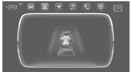
При возникновении опасности лобового столкновения на приборной панели отображается предупреждающий интерфейс и подается звуковой сигнал.
