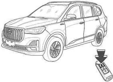
Когда все двери, включая дверь багажника, закрыты и двигатель не работает, нажмите на ключе кнопку LOCK для запираения дверей. При этом указатели поворотов мигнут один раз.
