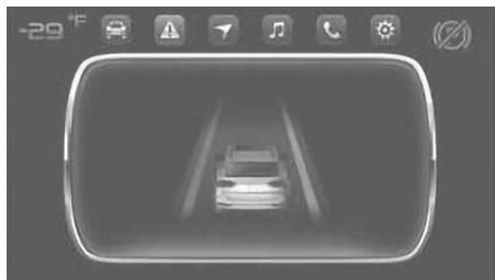
При выходе автомобиля за пределы полосы движения на приборной панели отображается предупреждающий интерфейс и подается звуковой сигнал.
